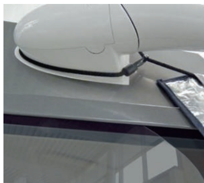
Befestigungsbeispiel mit Gummispanner am Außenspiegel
