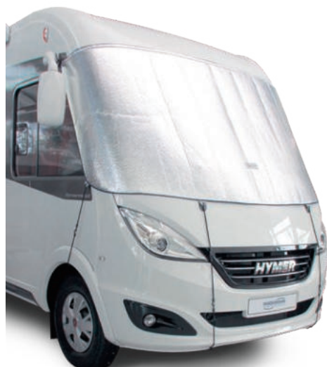
Befestigungsbeispiel mit Gummispanner am Außenspiegel
